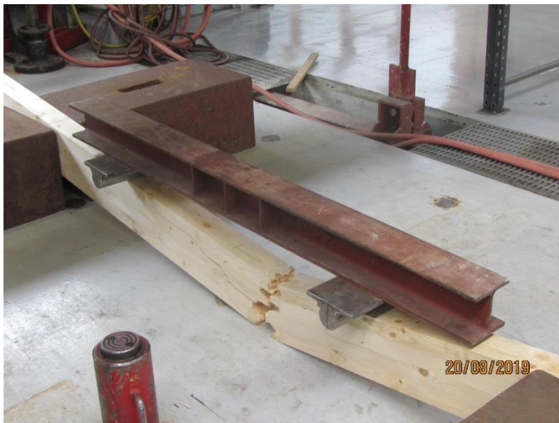
Mynd 31. Límtrésbiti eftir prófun (óvenju þverbrotinn).
