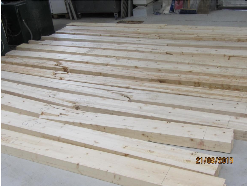
Mynd 38. Yfirlitsmynd af bitunum eftir brot. Allt hrein togbrot og hvergi vottar fyrir þrýstingsbroti í efri hluta bitana við skoðun (þar sem þrýstispenna er við prófunina).
