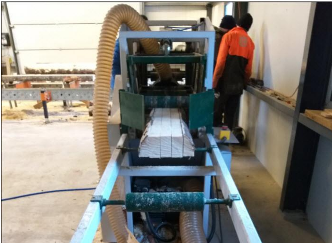
Mynd 8. Rammasög. Verið að saga límtrésfjalir 3 stykki 50X100 mm.
